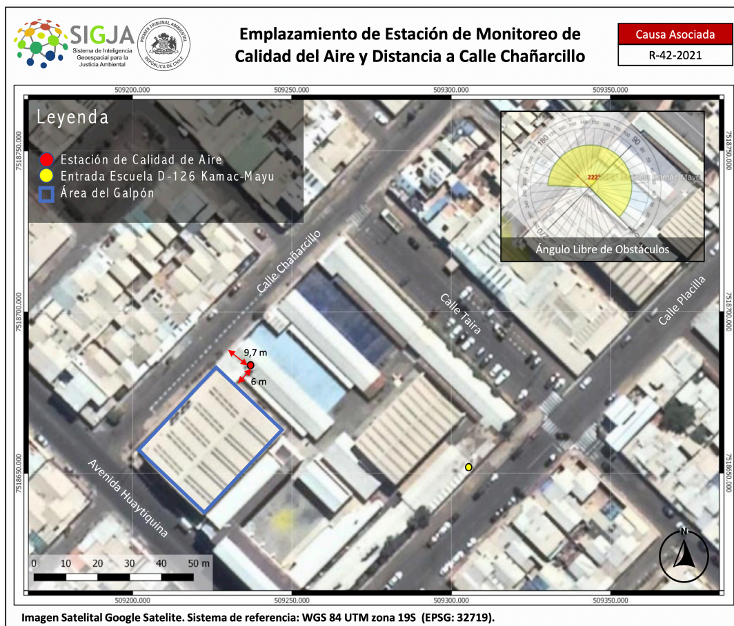
Figura 2. Emplazamiento de Estación de Monitoreo de Calidad del Aire Escuela D-126 Kamac-Mayu y detalle de distancia a calle Chañarillo, distancia y ángulo libre de obstáculos.
